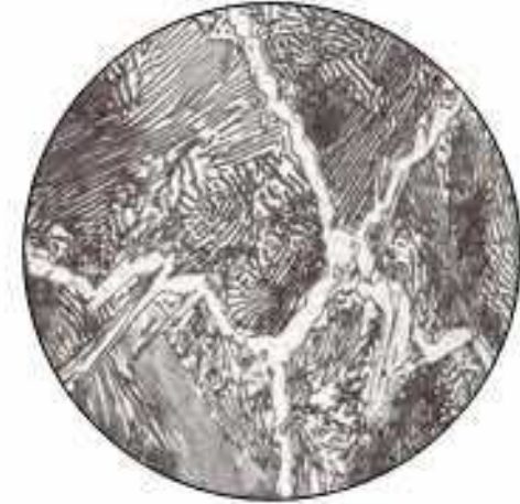
% 1.1 karbonlu ötektitüstü çeliğin mikroyapısı. Tane sınırlarında görünen beyaz bölgeler 2. Sementit fazıdır
