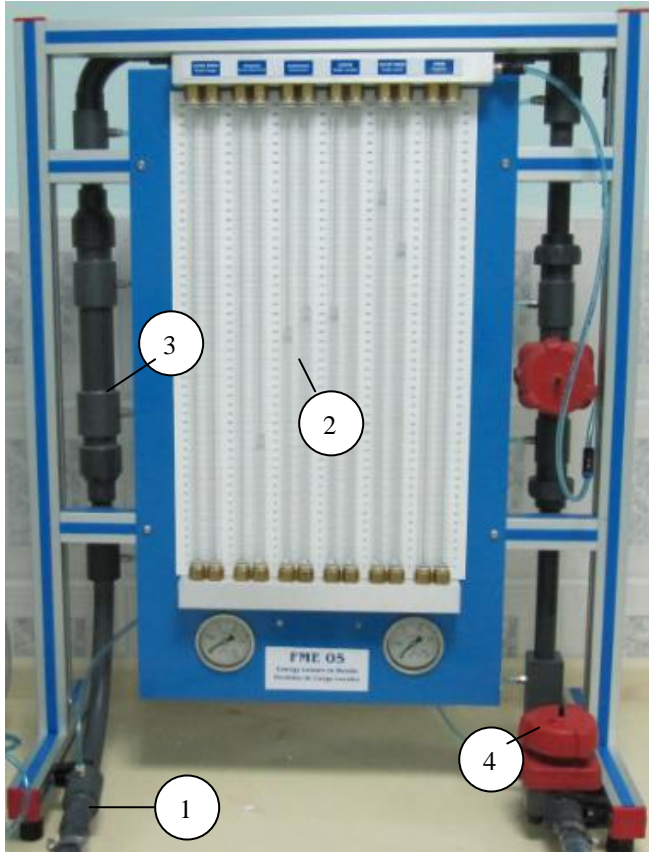
Şekil 2.8. Yerel kayıpları ölçüm deney düzenegi
