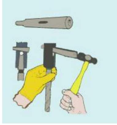
Şekil.1.2: Konik saplı matkabin ve mors kovanın tezgâhtan sökülmesi
