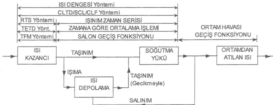
Şekil 1. Soğutma yükü yöntemlerine göre ısı geçişleri [2, 5].
