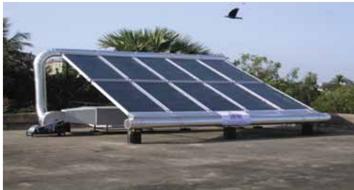
Şekil 33. Termal güneş enerjisinin kurutmada kullanımı.
