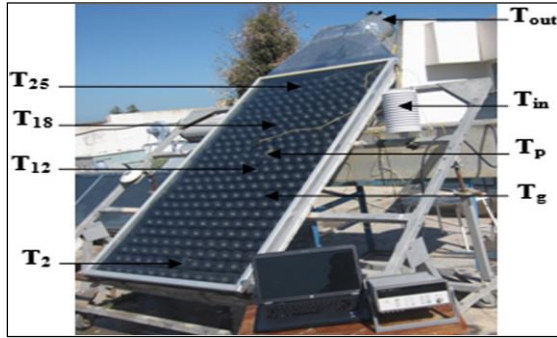
Şekil 10. Gizli enerji depolamalı hava kollektörü.
