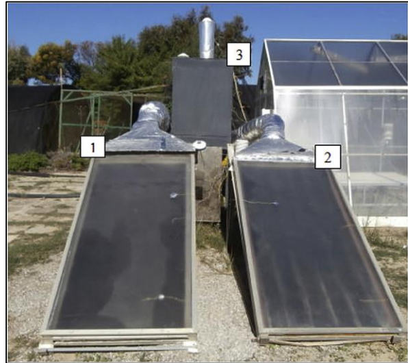
1)Güneş Enerji Akümülatörü 2) havalı güneş kolektörü 3 ) kurutma odası
