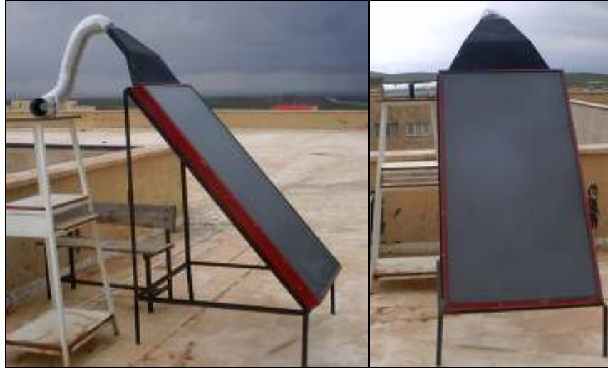
Şekil 5. İmalatı yapılan havalı güneş kolektörünün resimleri
