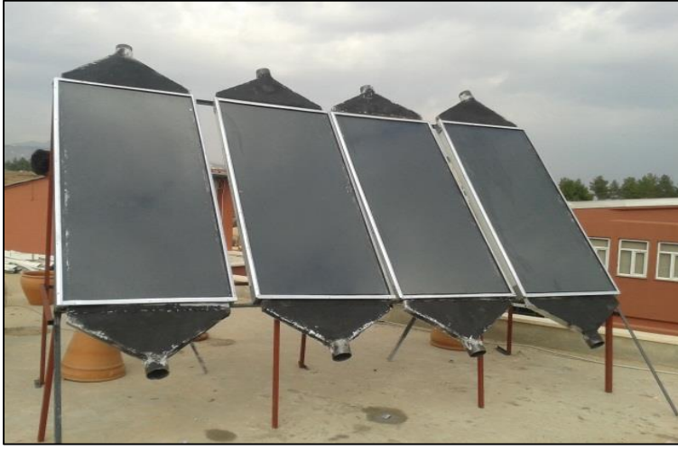
Şekil-4 İmalatı tamamlanmış havalı güneş kollektörleri
