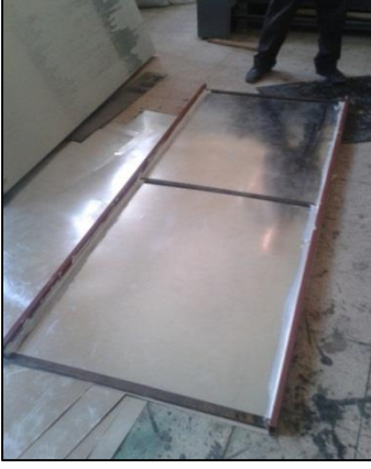
Şekil-3 Kollektör için hava kanalı imalatı
