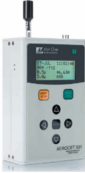
Şekil 1. Partikül madde ölçer
