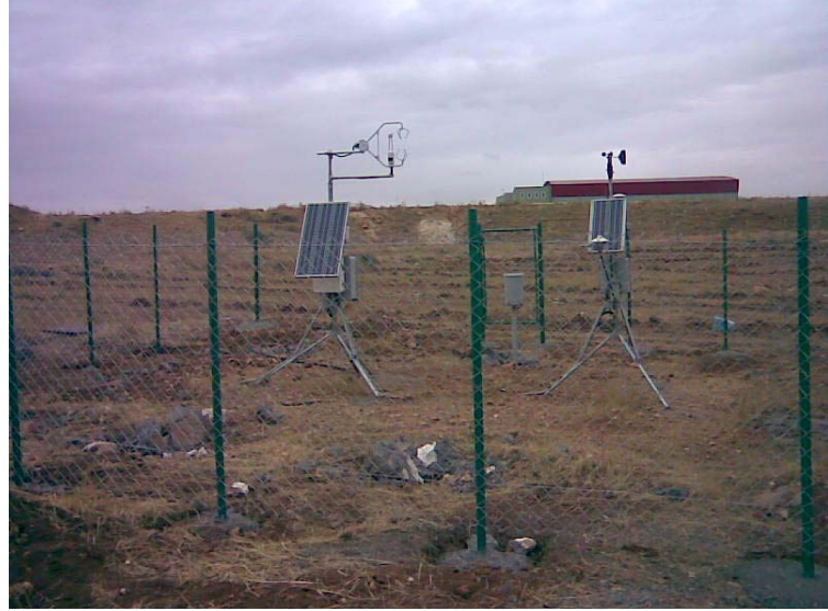
Şekil 2. Osmanbey yerleşkesi otomatik meteoroloji istasyonu
