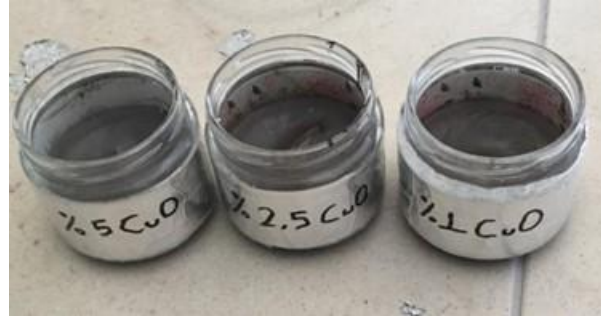
Şekil 2. %1, %2.5 ve %5 oranlarında CuO nanopartikül katkılı parafin numuneleri
