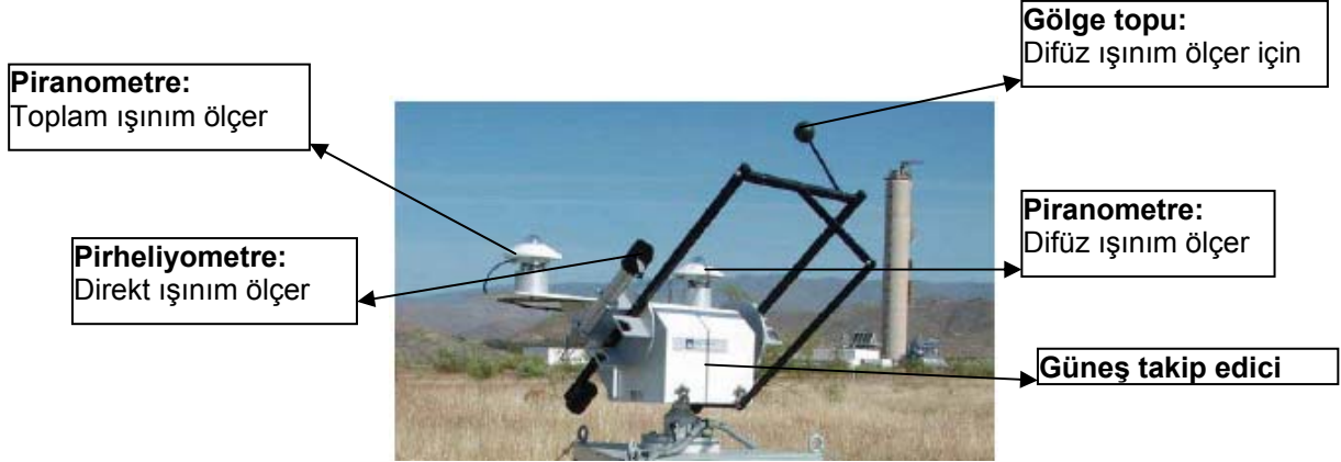
Şekil 2. Yatay Düzleme Gelen Güneş Işınımının Tüm Bileşenlerini Ölçen Sistem.
