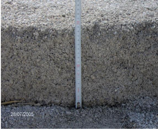
Resim 11.12: Şevlerde kum serimi ve üst yapı beton kalınlığının tayini.
