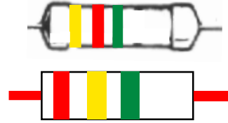
1 2 3 Şekil 1.46: Üç renk halkalı kodlama
