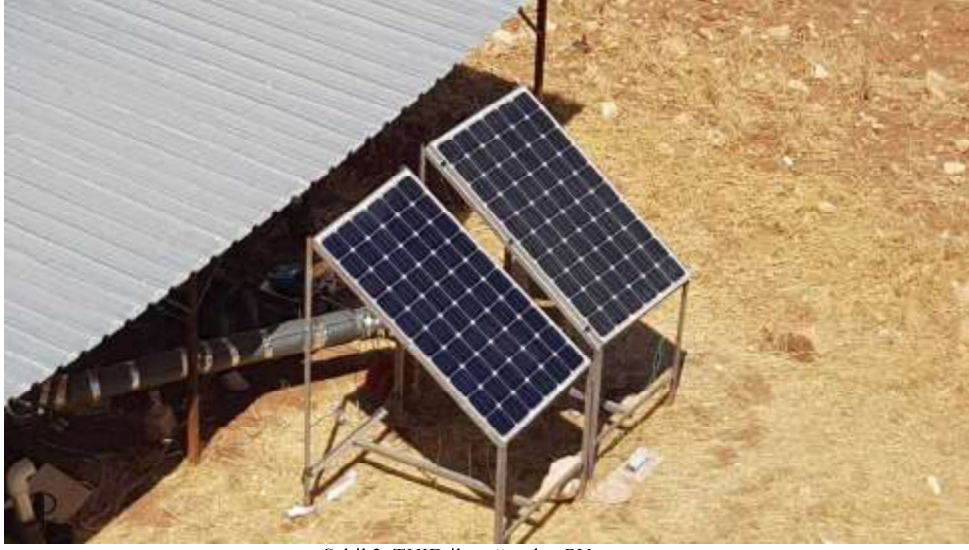
Şekil 3. THID ile soğutulan PV system
