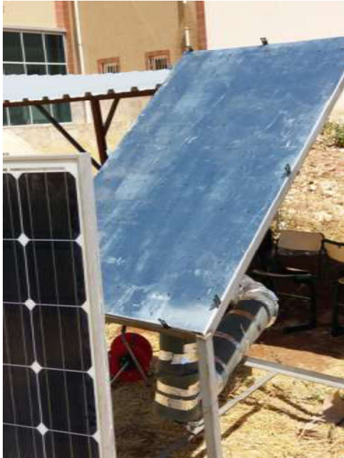
Şekil 4. PV panele montajı yapılan ara parça, PV Panel, THID sistemi ve ölçüm cihazının gösterimi
