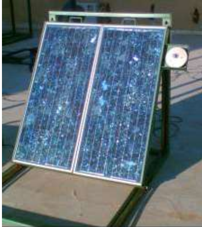
Şekil 1. Deneylerde kullanılan; (a) eğim açısı ayarlanabilir ergonomik sehpa, (b) data ölçüm-kayıt sistemi
